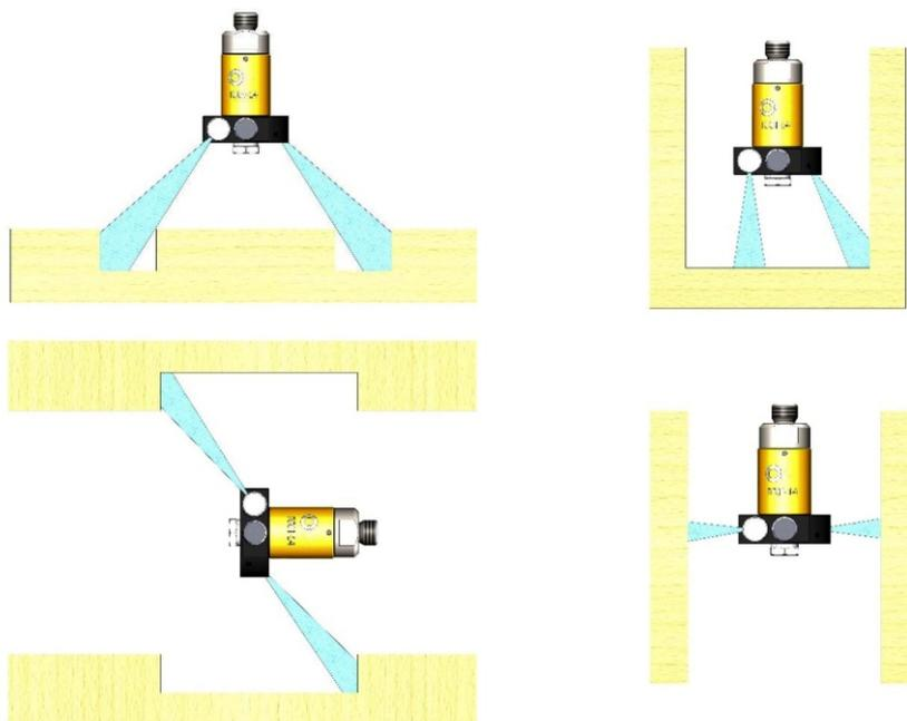
Le design avancé de ce composant assure une vitesse de rotation stable et régulée, indépendamment des paramètres choisis (pression d'alimentation et diamètre des orifices de soufflage).
